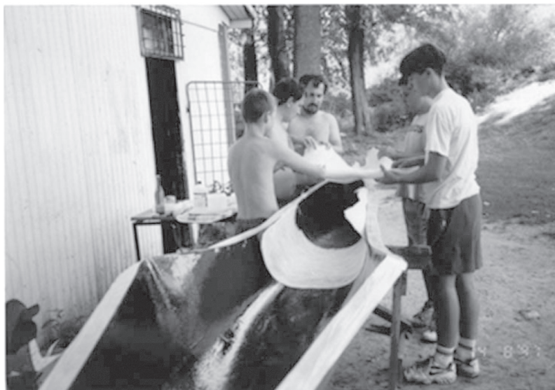
Slika 3. Izrada čamaca od poliesterske smole i staklenih vlakana kod KKK Varteks
