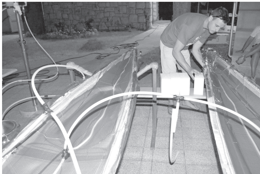
Slika 5. Izrada čamca vakumskom tehnikom
